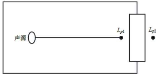
图7.3-1室内声源等效为室外声源图例
