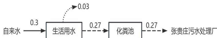
图 2-1 本项目水平衡图 单位：m<sup>3</sup>/d
