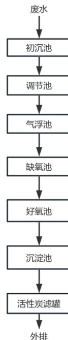
图8 污水处理工艺流程图
